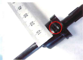
フロート式の排出オリフィス部
